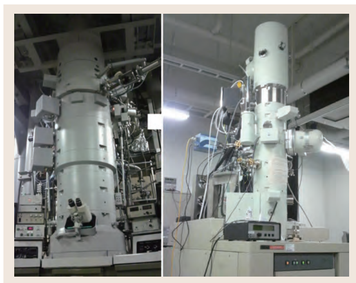
図1 医学・生物学専用 1MV 超高压電子顕微鏡 H-1250M (左) とエネルギー分光型 200kV 位相差クライオ電子顕微鏡 JEM2200FS (右)
