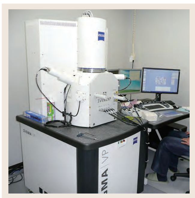
図1 連続ブロック表面走査型電子顕微鏡 (SBF-SEM) Gatan 3view - Zeiss Σ IGMA/VP
